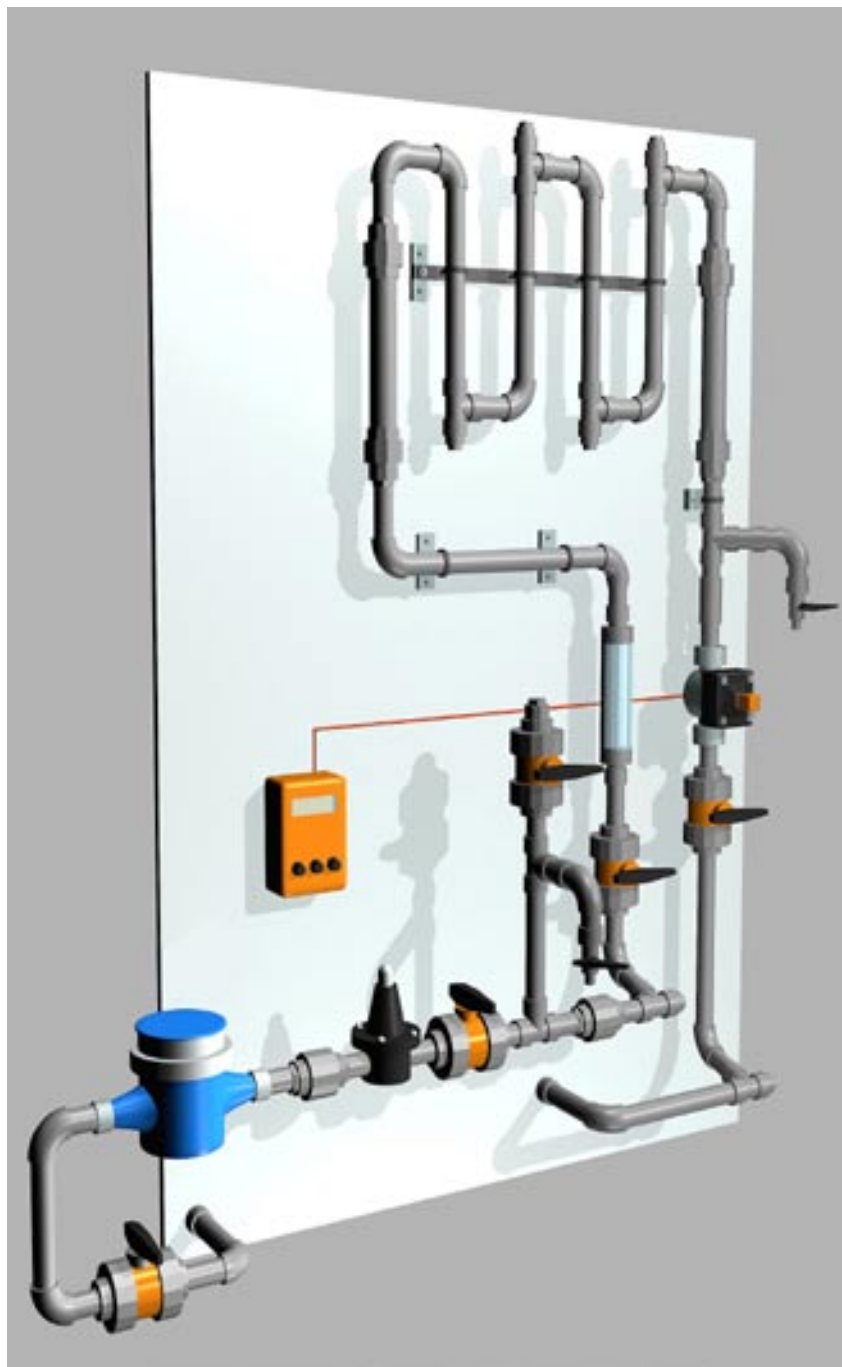
Fig. 2: Paneles para la colocación de testigos
