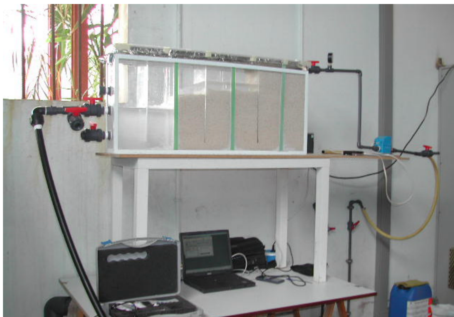
Figura 2: Planta piloto de diseño horizontal para la dosificación de carbonato cálcico.
