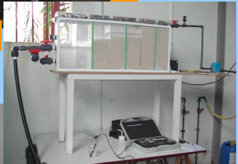
Planta piloto horizontal de 7 celdas (2003)
