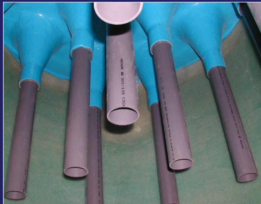
Depósito dosificador de carbonato cálcico tipo Aquatron ® para 316 m 3 /d.
