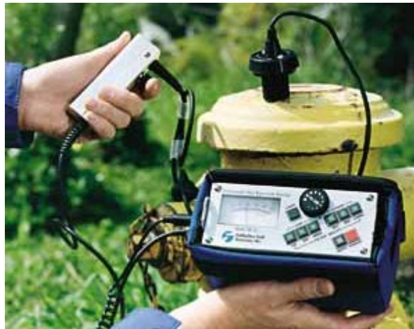
Foto 2. Examen de fugas en una boca de riego
